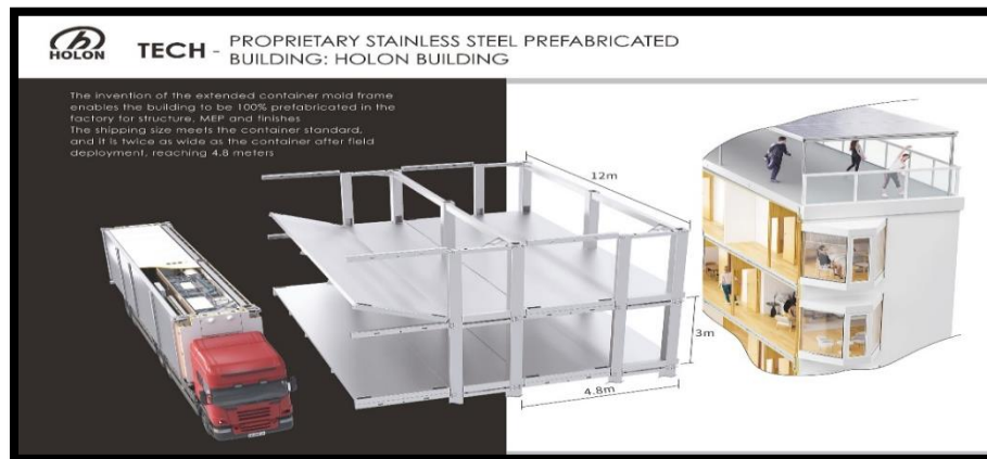
ساختمان پیش‌ساخته و بدون بتن هولون با قابلیت بازیافت حرارت اتلافی
